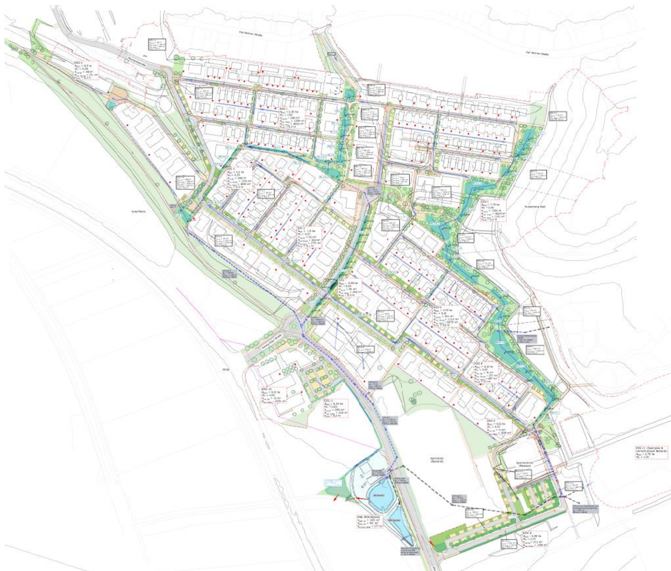
Abbildung 6: Übersichtslageplan Regenwasserentwässerung Konversionsgebiet "Ellwangen Süd"
